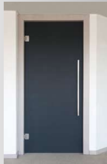
Deur met verchroomde veerscharnieren Glasstype: grijs gezuurd, sGG PARSOL GRUIS SATINOVO MATE SECURIT Dikte: 10 mm
