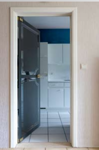
Deur met messing onderdelen Glastype: sgg PARSOL GRIJS SECURIT Dikte: 8 mm
